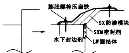
图1 有错台伸缩缝防渗施工布置示意
