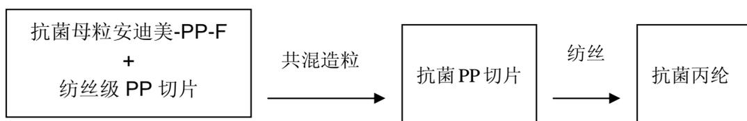
抗菌丙纶长丝的纺丝温度设定为 230-245℃，纺丝速度 800m/min，长丝纤维产品的纤度 1dpf，拉伸强度 2.27N/tex，伸度 10.5%。用美国 AATCC100-1999 标准和日本 JIS L 1902-1998 标准的方法，测定抗菌纤维及其织物的抗菌性能，结果表明，与织物接触 18-24 小时的大肠
